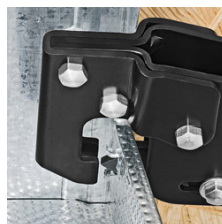
Het ponsgereedschap wordt door de plaat gedrukt
