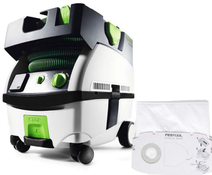
Festool CTL Mini stofzuiger met 3,5 meter afzuigslang Ø 32/27 mm (of gelijkwaardig) en SC FIS-CT MINI/5 stofzak Stofzak vervangen na elke 70 boorgaten bij boorgaten Ø 12 mm en diepte 60 mm
